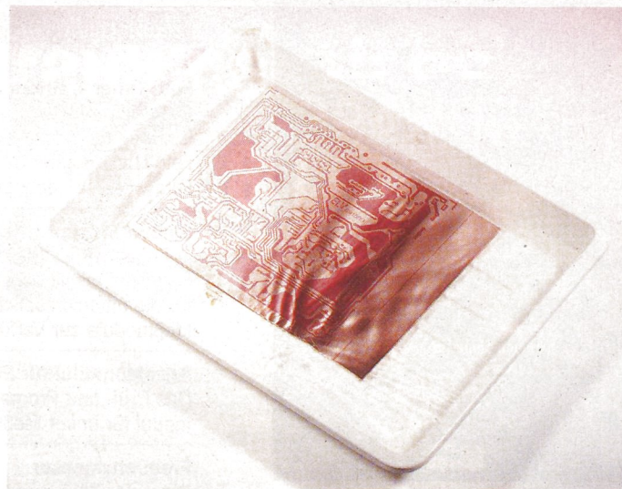
Während des Ätzvorgangs muß die Entwicklerschale ständig bewegt werden
